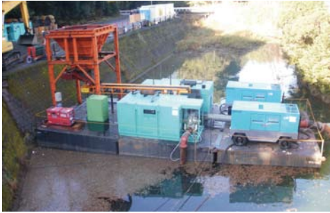
土砂直接投入システム
