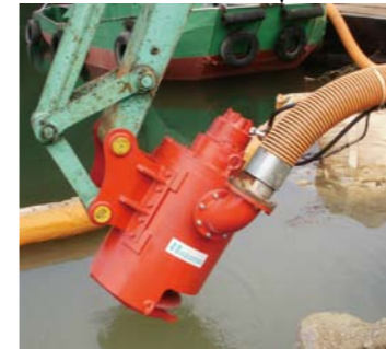
スクリュー破碎機 油圧で礫を破碎して吸引します
