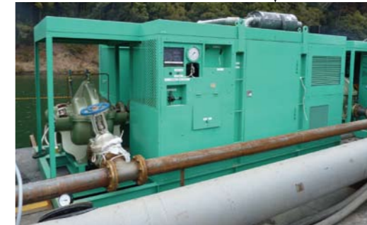
超高压ポンプ：圧力 1.5MPa、流量 5m 3 /min、2 台
