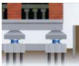
免震レトロフィット 建物の外観や機能を全く変えることなく、既存の建物を免震化します。
